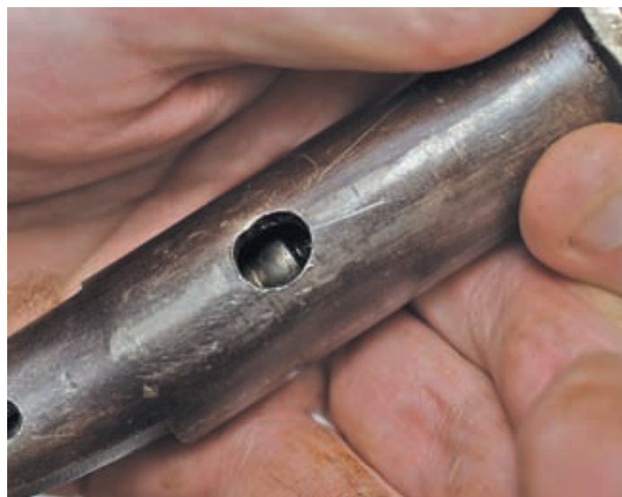
Отверстие, через которое шептало взаимодействует со штоком
