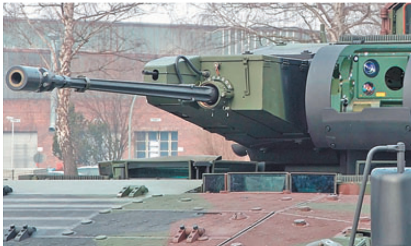
В состав вооружения новой БМП Рута входит 30-мм автоматическая пушка со спаренным пулемётом MG 4 (боекомплект 400 выстрелов и 2000 патронов, при этом 50 % боезапаса готово к стрельбе)
