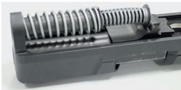
Возвратный механизм состоит из двух цилиндрических пружин разного диаметра
