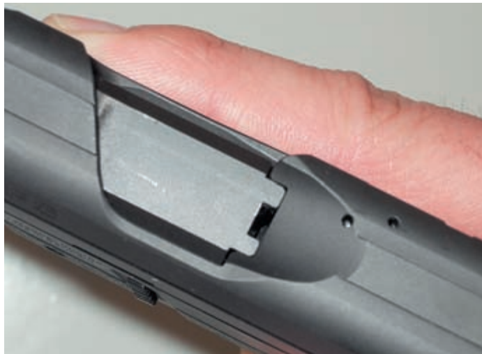
Хорошо виден вырез в казённой части ствола, через который можно увидеть, есть ли патрон в патроннике или нет
