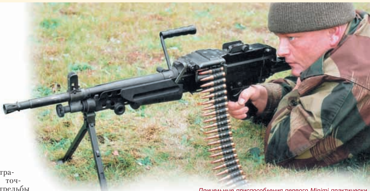
Прицельные приспособления первого MiniM1 практически идентичны таковым у пулемёта M249 SAW. Газовый регулятор представляет собой упрощённый вариант регулятора пулемёта FN MAG 58
