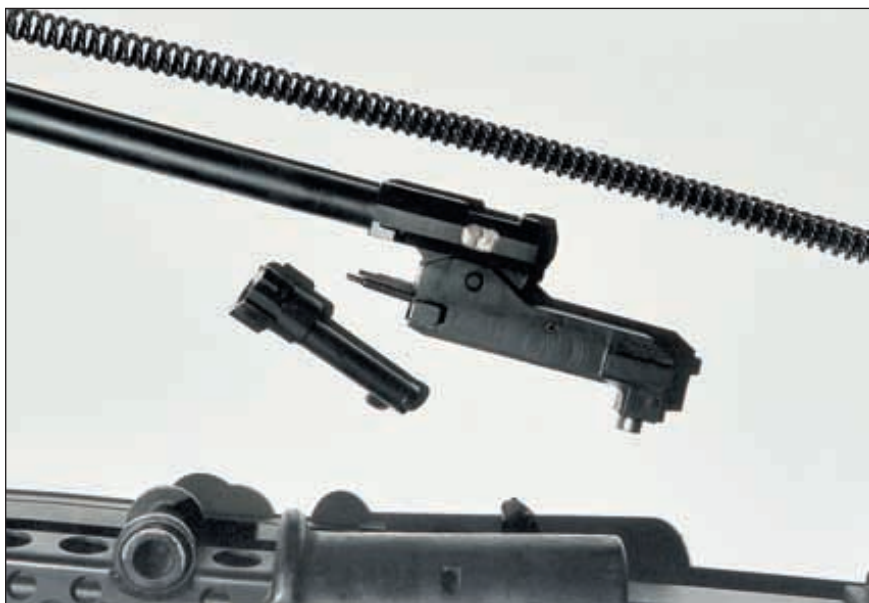
Детали второго прототипа пулемёта Miniimi. Поворотная личинка затвора, затворная рама с газовым поршнем, многожильная пружина возвратного механизма
