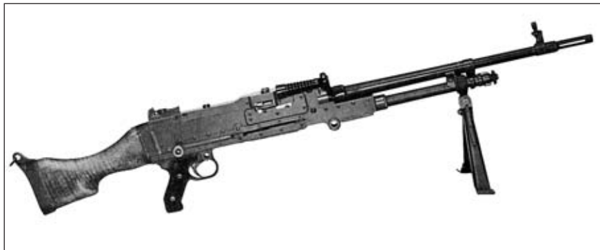
Пулемёт FN MAG 58. Некоторые элементы этого пулемёта переключали на опытные образцы FN Minimi под патрон 7,62x51. На фото шведский пулемёт (здесь он был принят на вооружение под наименованием Ksp 58)
