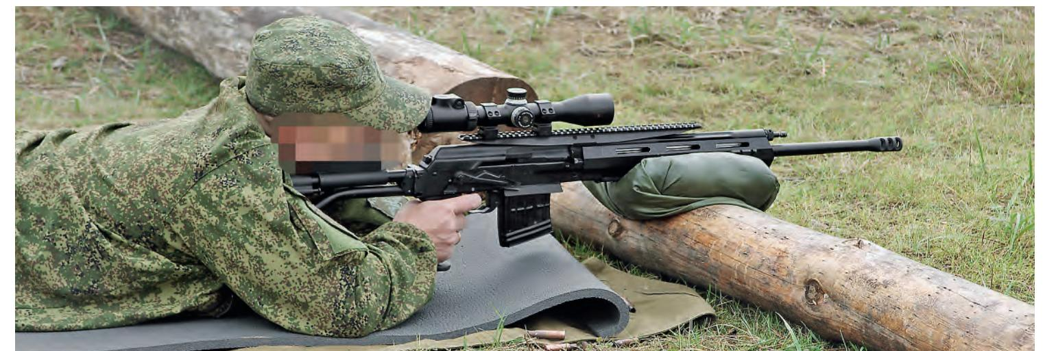
ВПО-129 калибра 7,62x54 предполагает использование штатных магазинов от СВД, вмещающих 10 патронов. На фото изображена винтовка со складывающимся металлическим прикладом постоянной длины и регулируемой щекой
