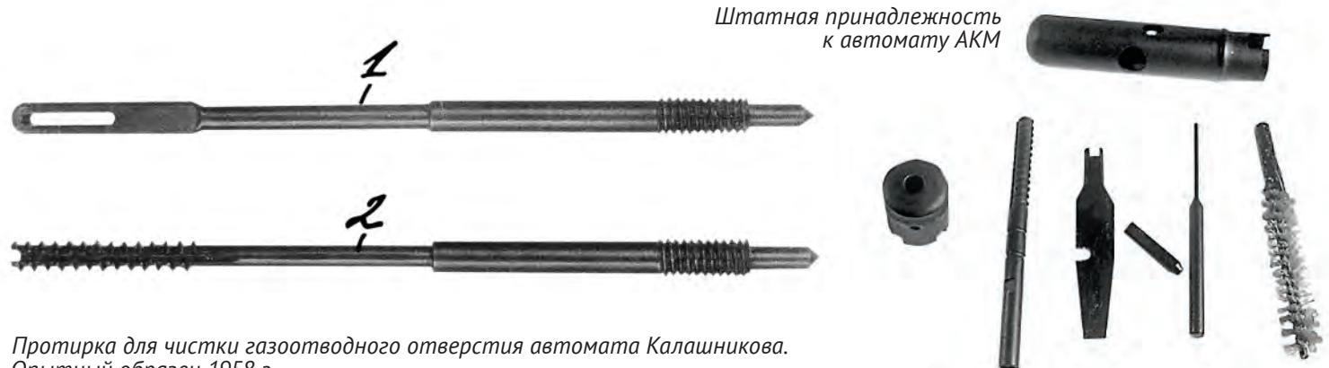
Протирка для чистки газоотводного отверстия автомата Калашникова.
