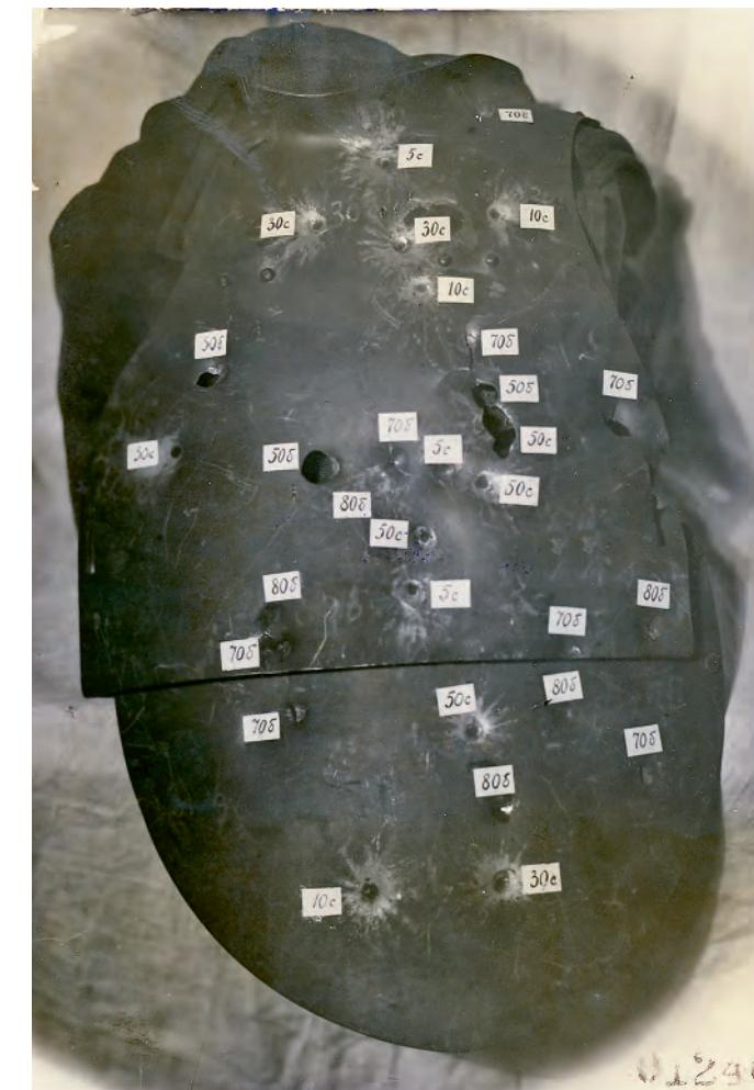
Вид стального нагрудника СН-42 со следами попаданий пуль. Цифрами обозначены дальности стрельбы в метрах. Индекс «б» означает пулю со стальным сердечником, индекс «с» – пулю со свинцовым сердечником
