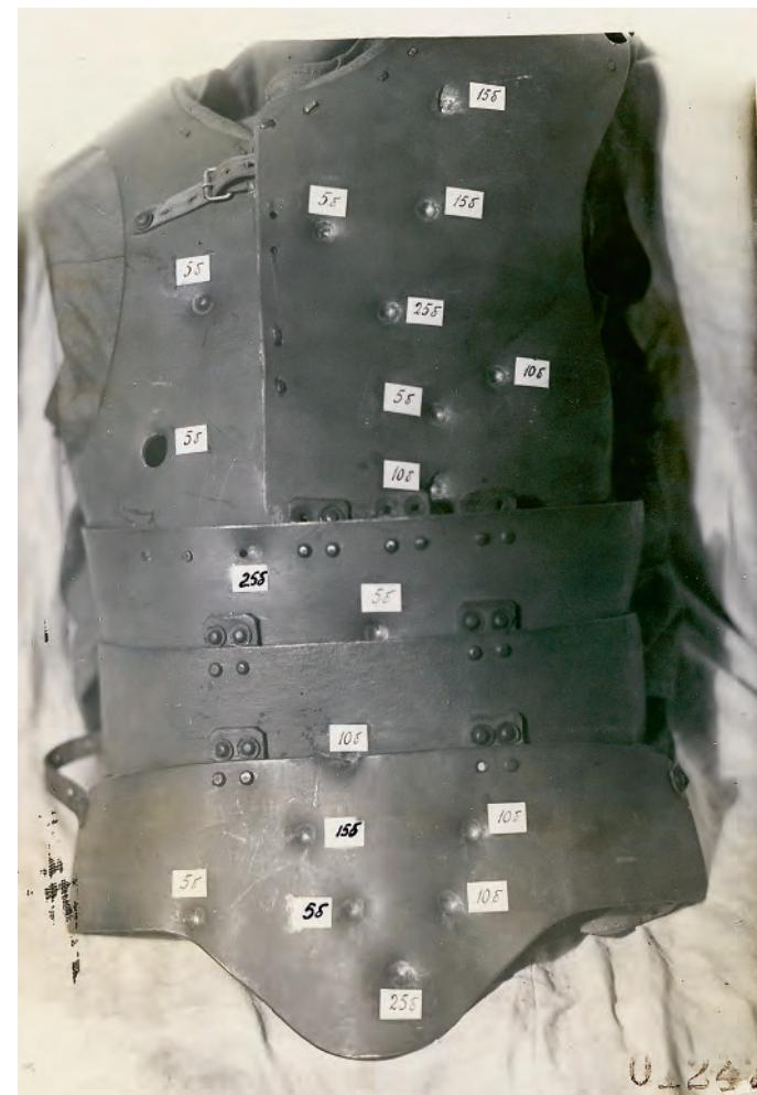
Вид стального панциря ПЗ-3ИФ-20 завода № 7, со следами попаданий пуль. Цифрами обозначены дальности стрельбы в метрах. Стрельба производилась только пулями со стальными сердечниками
