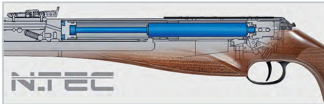
системы: N-Tec — Nitrogen Piston Technology: под этим подразумевается технология воздействия азота на поршень. В отличие от классических переломных винтовок пружинно-поршневого типа введения у моделей 340 N-Tec пружина срабатывает за счёт сжатого азота.
