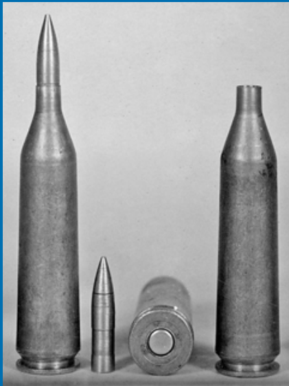
Основной патрон со спецпулей, спецпуля и гильза
