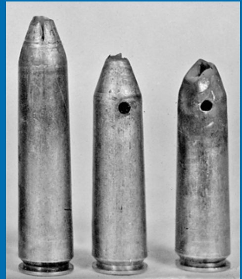
Истечение пороховых газов при сгорании мощного порохового заряда происходило столь интенсивно, что обрывало дульца обеих гильз, фрагменты которых вылетали вслед за пулей
