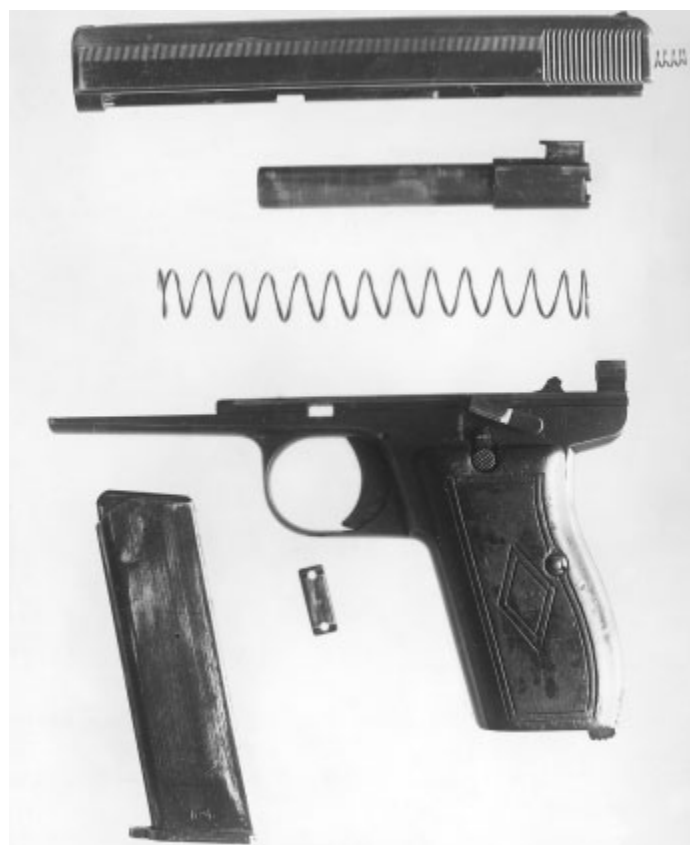
Общий вид и неполная разборка 7,65-мм опытного пистолета Симонова, испытывавшегося в 1947 году
