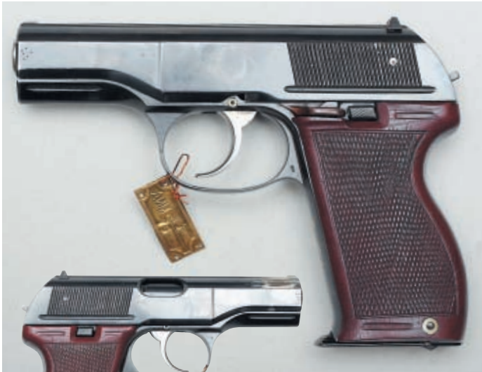
Общий вид и неполная разборка 9-мм опытного пистолета Барышева, испытывавшегося в 1948 году
