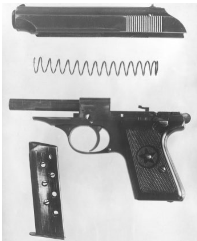
Общий вид и неполная разборка 7,65-мм опытного пистолета Севрюгина, испытывавшегося в 1947 году
