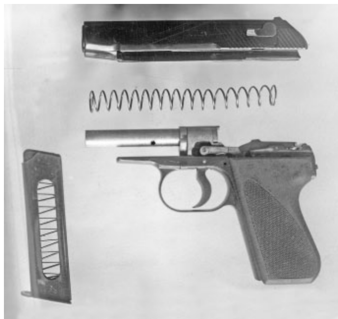
Общий вид и неполная разборка 9-мм опытного пистолета Воеводина испытывавшегося в 1947 году
