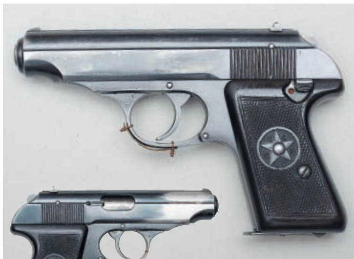
Общий вид и неполная разборка 7,65-мм опытного пистолета Севрюгина, испытывавшегося в 1947 году
