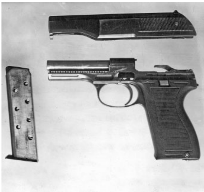
Общий вид и неполная разборка 9-мм опытного пистолета Барышева испытывавшегося в 1947 году
