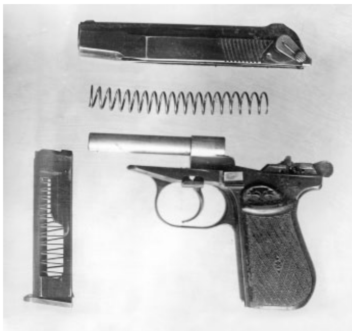
Общий вид и неполная разборка 9-мм опытного пистолета Макарова испытывавшегося в 1947 году
