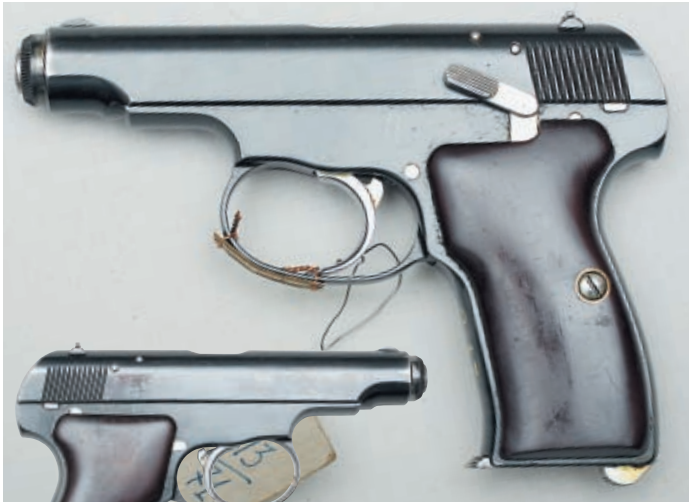
Общий вид и неполная разборка 7,65-мм опытного пистолета Коровина, испытывавшегося в 1947 году
