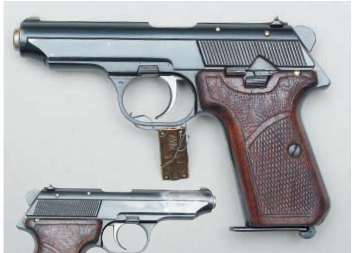
Общий вид и неполная разборка 7,65-мм опытного пистолета Ракова, испытывавшегося в 1947 году
