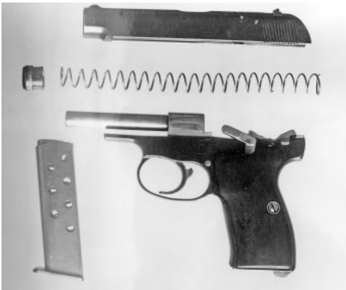
Общий вид и неполная разборка 7,65-мм опытного пистолета Коровина, испытывавшегося в 1947 году
