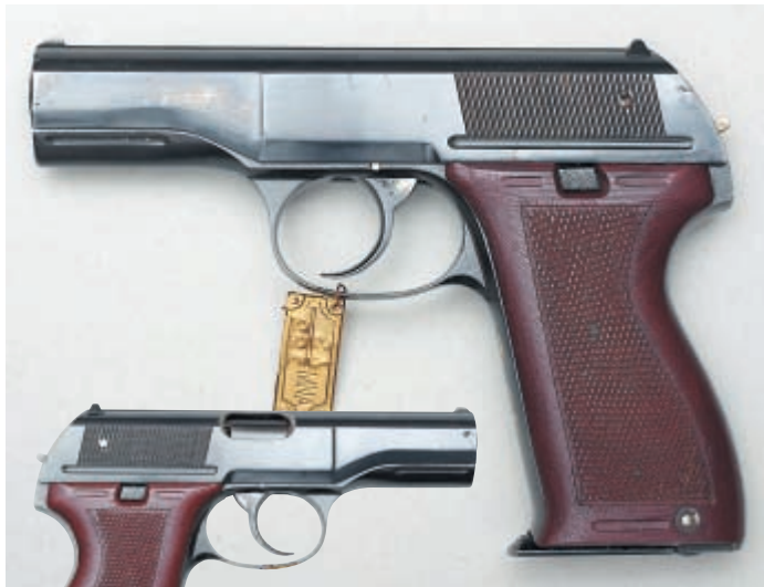
Общий вид и неполная разборка 9-мм опытного пистолета Барышева испытывавшегося в 1947 году
