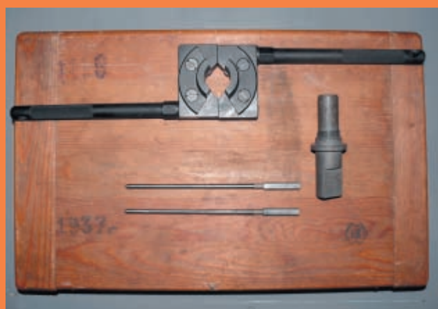
Ил. 1, 2. Оснастка для контроля и (при необходимости) приведения в норму качки ДТК автомата АК74
