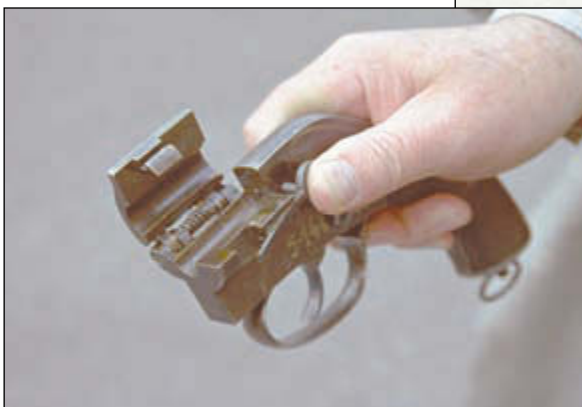
Илл. 9. Сигнальный пистолет, прототипом для которого послужил спортивный немецкий пистолет Eisfeld
