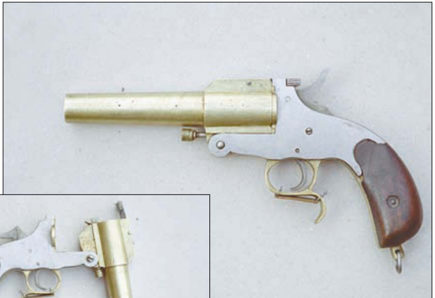
Илл. 8 Сигнальный пистолет сконструированный на базе револьвера «Смит-Вессон» образца 1874 г. У пистолета увеличена длина ствола, изменена конструкция экстрактора стреляных гильз и защёлки ствола
