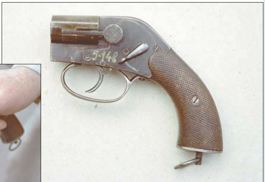
Илл. 9. Сигнальный пистолет, прототипом для которого послужил спортивный немецкий пистолет Eisfeld
