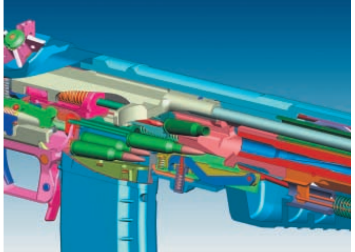
Эти две схемы дают представление о взаимном положении подвижных частей автомата при перезарядании. На верхней схеме показан момент отражения стрелянной гильзы из ствольной коробки – затворная рама движется назад, а выталкиватель выдвигает очередной патрон на подаватель. Внизу затворная рама движется вперёд – затвор готов «снять» патрон с подавателя и дослать его в патронник
