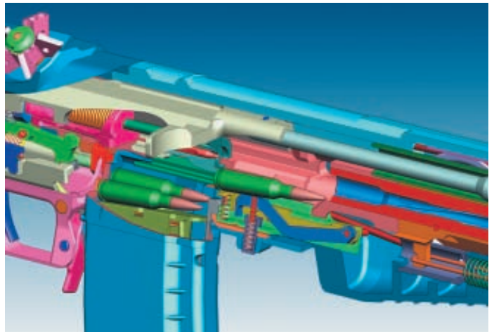
Эти две схемы дают представление о взаимном положении подвижных частей автомата при перезарядании. На верхней схеме показан момент отражения стрелянной гильзы из ствольной коробки – затворная рама движется назад, а выталкиватель выдвигает очередной патрон на подаватель. Внизу затворная рама движется вперёд – затвор готов «снять» патрон с подавателя и дослать его в патронник
