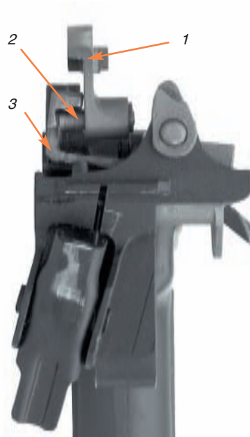
Вид спереди на спусковой механизм и шептало с разобщителем (на фото шептало отделено от затворной рамы). 1 – шептало, 2 – подпружиненный разобщитель, 3 – спусковая планка. Обратите внимание на наклонное положение защёлки магазина. Наклон магазина обусловлен борьбой за минимальный габарит оружия по ширине из-за особенностей конструкции автомата, например наличия выталкивателя
