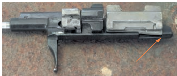
Курок может не только наносить удар по ударнику под действием разжимающейся боевой пружины, но и приходит в крайнее переднее положение будучи сцепленным с затворной рамой. Это необходимо при производстве второго выстрела при стрельбе «двойками» в высоком темпе. Место сцепления курка с затворной рамой показано стрелкой
