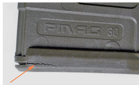
На фотографиях приведены дефекты PMAG 30, образовавшиеся после падений снаряженного магазина
