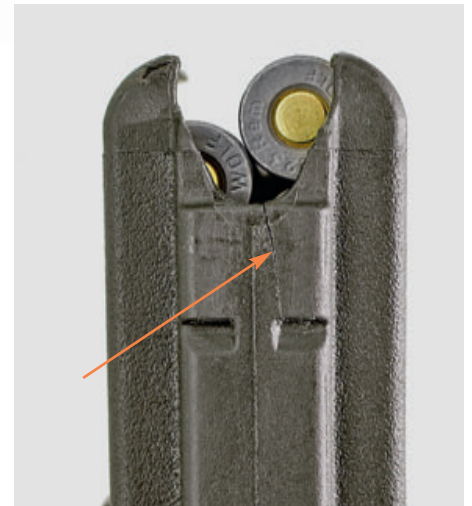
Дефект магазина PMAG модельного ряда 2011 года после падений
