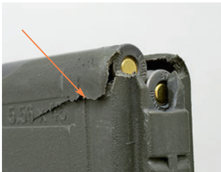
На фотографиях приведены дефекты PMAG 30, образовавшиеся после падений снаряженного магазина
