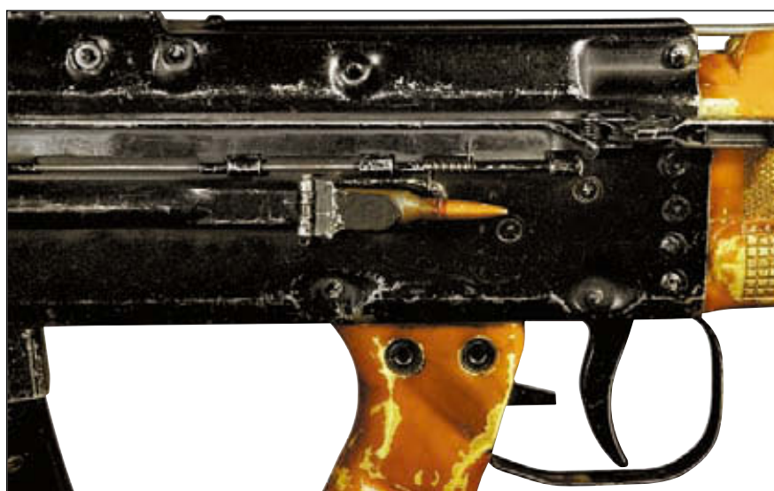
Удаление стреляной гильзы (или патрона при разряжании) из кожуха ствольной коробки производится через окно над рукояткой управления огнём, прикрытое подпружиненной крышкой
