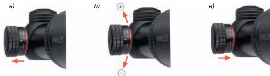
Прибор подсветки прицельной марки: а) включение подсветки, б) изменение интенсивности свечения марки, в) выключение подсветки
