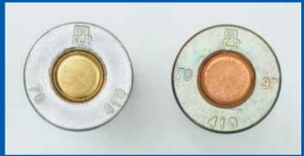
Маркировки, нанесённые на донную часть гильзы патронов Барнаульского станкостроительного завода (ныне Барнаульский патронный завод)
