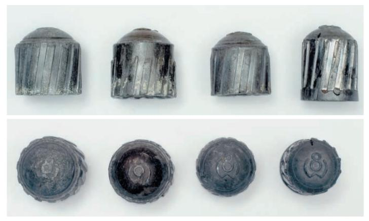
Польские пули W8 (аналог пули Фостера) различных калибров. На польских пулях W8 маркировка наносится на головную часть
