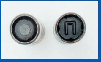
Способы заделки патрона с пулей Фостера Барнаульского станкостроительного завода (ныне Барнаульский патронный завод)
