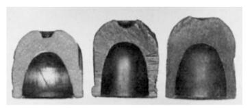
Продольный разрез пуль Фостера производства разных фирм. Слева направо: Winchester, Remington, Federal
