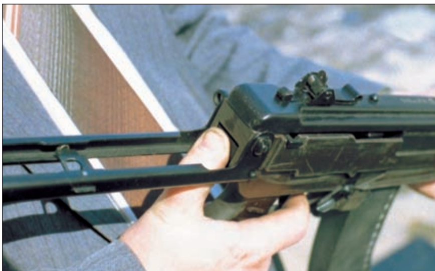
Защёлка, фиксирующая приклад в боевом положении, расположена за pistolетной рукояткой в задней части ложи
