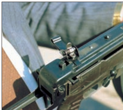
Для того, чтобы сдвинуть возвратный механизм вперёд и разъединить ствольную коробку с ложей, основание прицела необходимо повернуть на 90°
