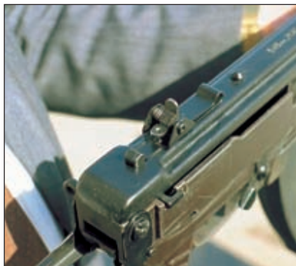
Перекидной диоптрический прицел автомата, расположенный на ствольной коробке, имеет две установки дальности стрельбы – 300 и 500 м
