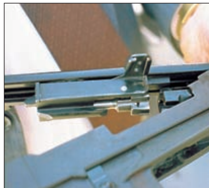
Затворная рама с затвором МА как бы подвешена в ствольной коробке. Это позволило сделать пластмассовую ложу простой и лёгкой
