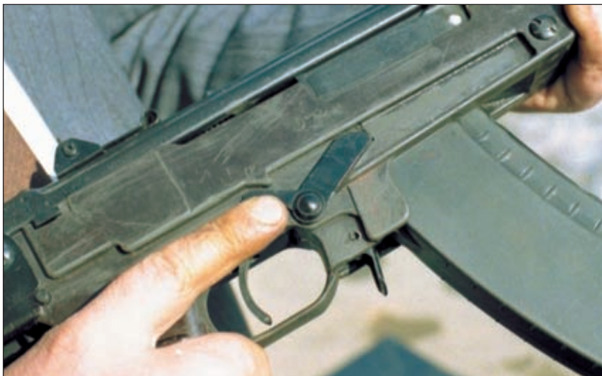
Предохранитель-переводчик режимов огня находится с правой стороны ствольной коробки и управляется указательным пальцем. Во включенном положении флажок предохранителя-переводчика перекрывает отверстие спусковой скобы. Это позволяет одновременно с охватом рукоятки на ощупь определить положение переводчика
