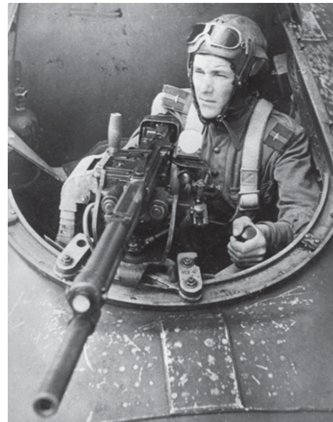
Универсальный пулемёт Березина (УБ) в турельном варианте на штурмовике Ил-2
