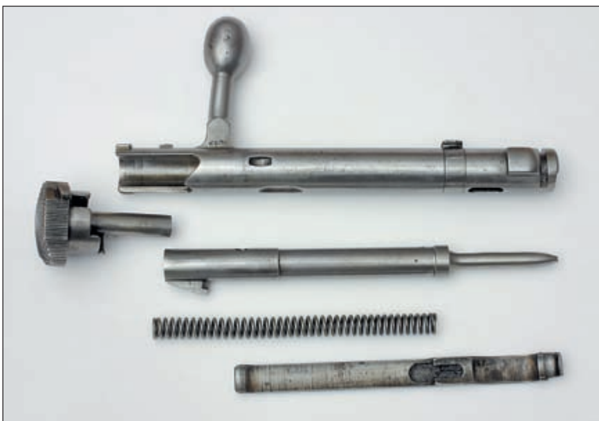
Неполная разборка затвора винтовки «тип 38»
