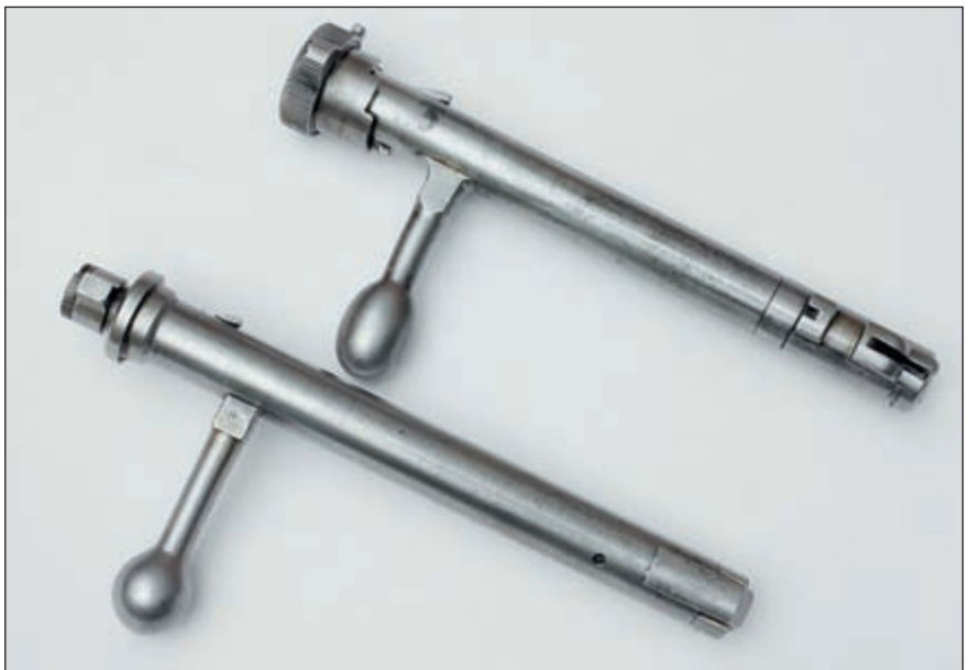
Затворы винтовок «тип 30» (внизу) и «тип 38»
