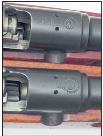
Видны клейма на патроннике сверху японская винтовка тип «38» калибра 6,5 мм, внизу винтовка мексиканского заказа 1910 г. под патрон 7x57 Mauser
