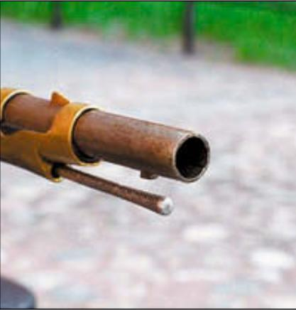
*Дульный срез с двумя нарезами канала ствола. Снизу дульной части располагается металлический прилив для крепления штыка*
