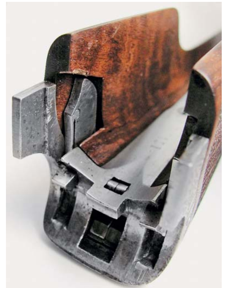
Эжектор вертикалки Дефурни. Несложно догадаться, какая толщина у сопрягаемой части затворной коробки
