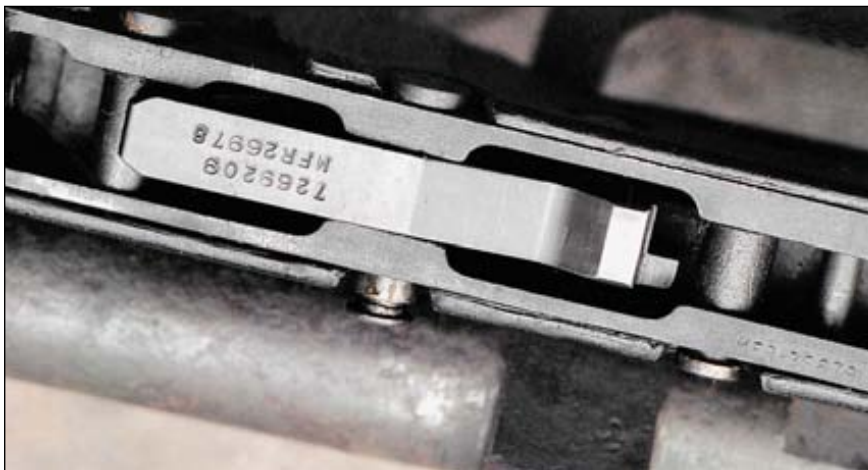
Да, шептало может быть установлено задом-наперёд – достаточно часто встречающаяся ошибка при сборке пулемёта
