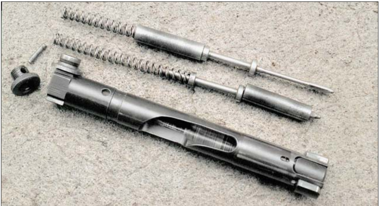
В полевых условиях сборка затворной группы М60 часто является проблемой. Сверху вниз: правильное взаимное расположение деталей ударного механизма, его неправильная сборка, узел ролика механизма подачи установлен задом-наперёд
