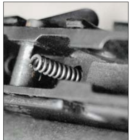
Необходимо отметить, что толкатель и пружина шептала спускового механизма могут быть перепутаны местами. На иллюстрации эти детали установлены именно в таком порядке
