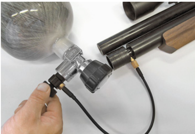
Заправка воздушного резервуара через порт, закрываемый сдвижной подпружиненной крышкой-кольцом
