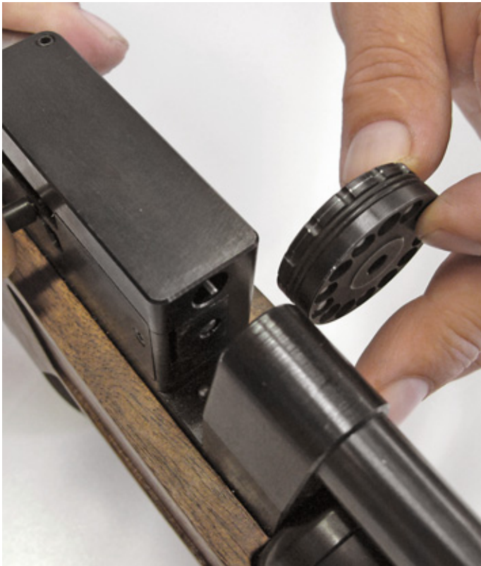
Установка барабанного магазина. Рукоятка перезарядки и ручка управления приводом магазина находятся в крайних задних положениях
