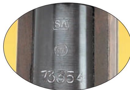
Слева направо: клейма на стволе винтовки М/39. «В» обозначает бельгийское производство. Клеймо PUOLUSTUSLAITOS, типичное для винтовок М/39 и М/91 – это не название фирмы-изготовителя, а обозначение владельца – финская армия; применялось в течение четырех месяцев до введения клейма SA
