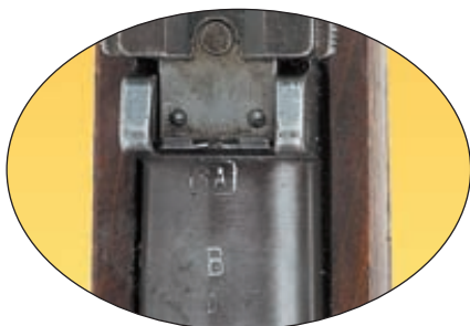
Слева направо: клейма на стволе винтовки М/39. «В» обозначает бельгийское производство. Клеймо PUOLUSTUSLAITOS, типичное для винтовок М/39 и М/91 – это не название фирмы-изготовителя, а обозначение владельца – финская армия; применялось в течение четырех месяцев до введения клейма SA
