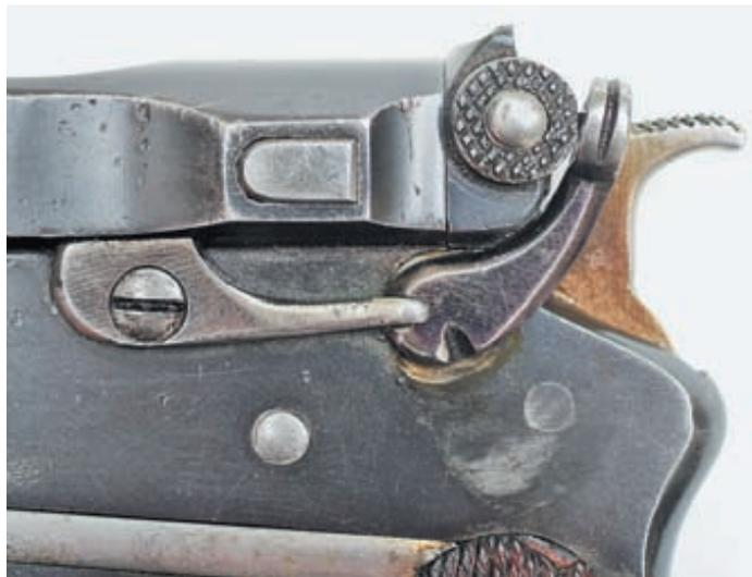
*Предохранитель флажкового типа пистолета Bergmann M-1896 № 2*
