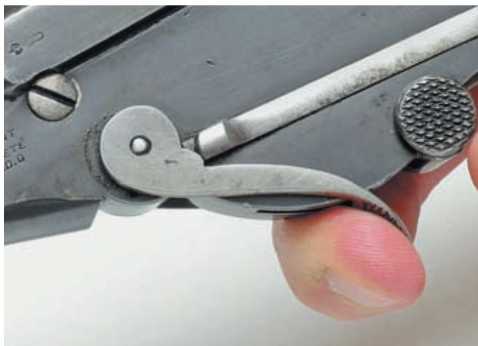
*Работа складного спускового крючка пистолета. Видно, как спусковой крючок взаимодействует с толкателем*
