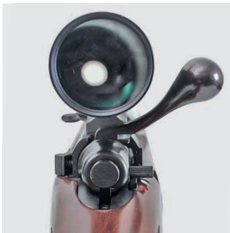
Благодаря трём боевым упорам «ремингтон» (справа) обеспечивает наиболее удобное перезаряжание за счёт малого угла поворота рукоятки
