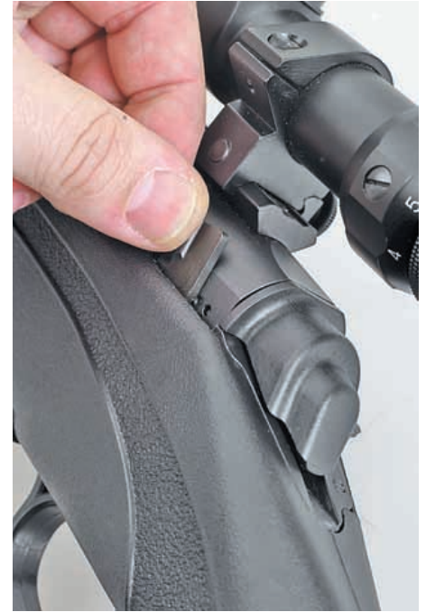
Для отделения затвора у «сабатти» (слева) нужно нажать боковую клавишу, у «ремингтона» (в центре) нажимается кнопка вниз, а у «мосберга» перед этой манипуляцией необходимо повернуть соответствующий флажок
