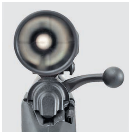
Благодаря трём боевым упорам «ремингтон» (справа) обеспечивает наиболее удобное перезаряжание за счёт малого угла поворота рукоятки
