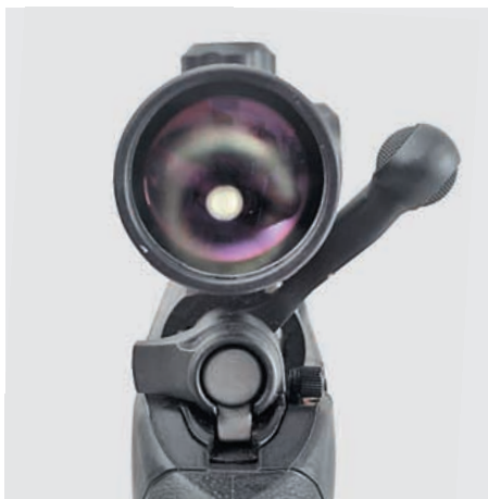
Благодаря трём боевым упорам «ремингтон» (справа) обеспечивает наиболее удобное перезаряжание за счёт малого угла поворота рукоятки
