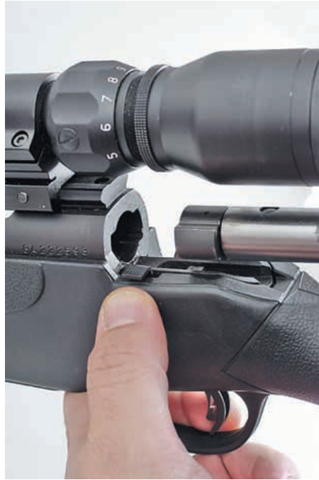
Для отделения затвора у «сабатти» (слева) нужно нажать боковую клавишу, у «ремингтона» (в центре) нажимается кнопка вниз, а у «мосберга» перед этой манипуляцией необходимо повернуть соответствующий флажок
