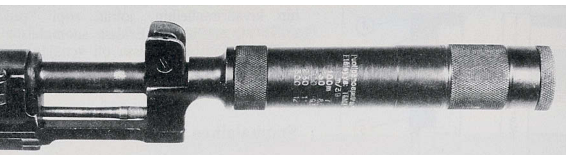
Финский прибор бесшумной и беспламенной стрельбы типа «Брамит» для установки на винтовку M39
