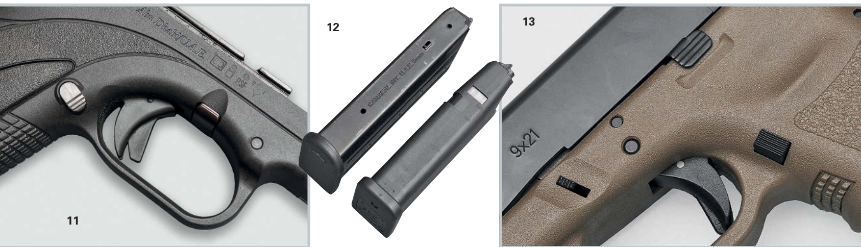
11. Безопасно: рычаг фиксатора магазина у пистолета Saagal можно привести в действие обеими руками. Предохранитель на спусковом крючке происходит от пистолета Glock. 12. Вдоволь: магазин пистолета Glock может вместить 17 патронов, у пистолета Saagal имеется даже 18 патронов. 13. Изменяемый: кнопка фиксатора магазина и рычаг затворной задержки пистолета Glock могут заменяться комплектными элементами других размеров. 14. Особенность: чтобы дать возможность закрепления лазерных прицелов и других принадлежностей, предприятие из Арабских Эмиратов оснащает свои пистолеты планкой снизу под стволом.
