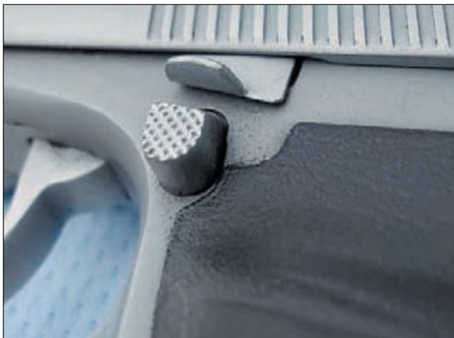
Доработанный пистолет оснащён компенсатором отдачи, уменьшающем подбрасывание пистолета при выстреле, а также кнопкой фиксатора магазина
