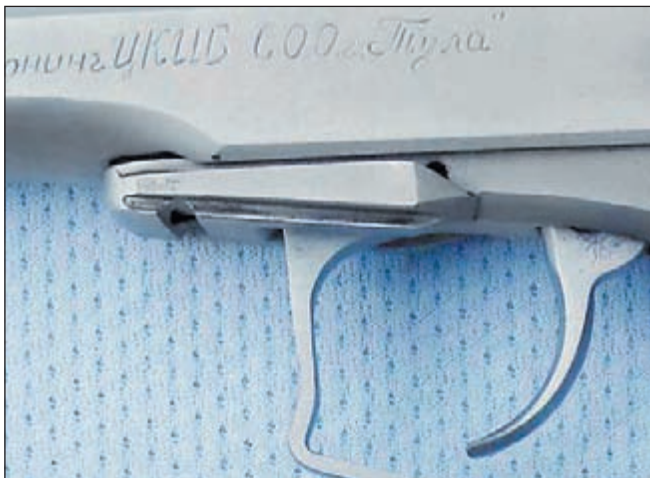
К рукоятке пистолета прикреплена алюминиевая направляющая горловина, призванная ускорить процесс смены магазина. В нижней передней части рамки пистолета установлен кронштейн для крепления коллиматорного прицела
