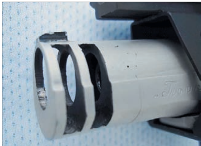
Доработанный пистолет оснащён компенсатором отдачи, уменьшающем подбрасывание пистолета при выстреле, а также кнопкой фиксатора магазина
