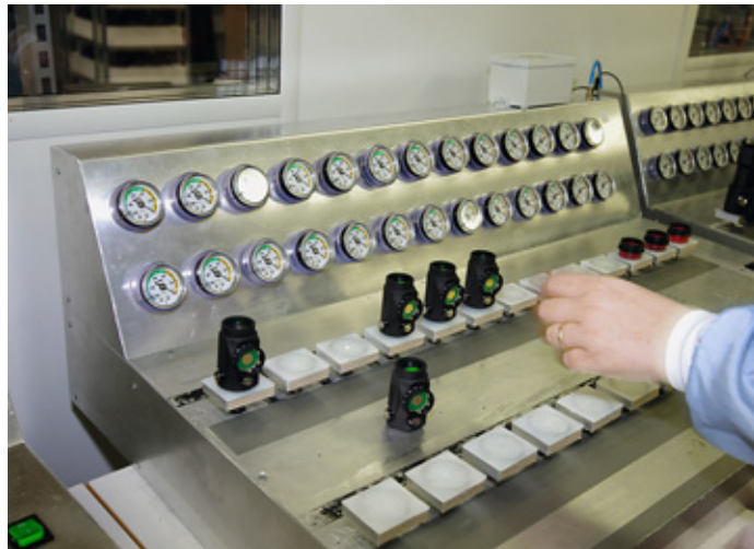
На вакуумных стандах проверяется качество вклейки линз каждого прицела Aimpoint
