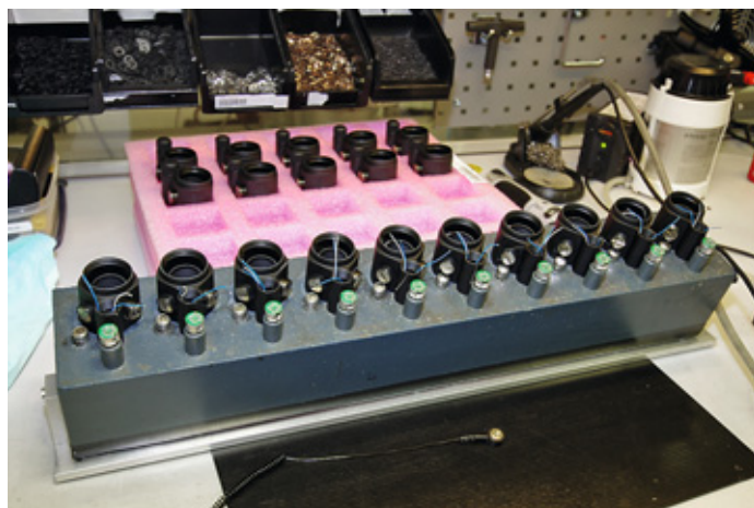
Рабочее место установки выключателей. Внизу виден провод от брашлета для снятия статического напряжения
