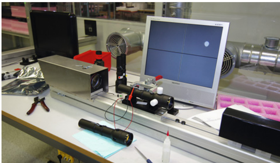
Фокусировка диода – одна из наиболее ответственных операций при сборке прицела. Мастер должен найти положение, при котором видимые на мониторе световые точки соберутся в одно пятно, и после этого зафиксировать диод специальным клеем. Кстати, на фокусировке диодов для прицелов серии Hunter (на одном из приведённых снимков) используется усовершенствованный стенд с большей точностью и производительностью
