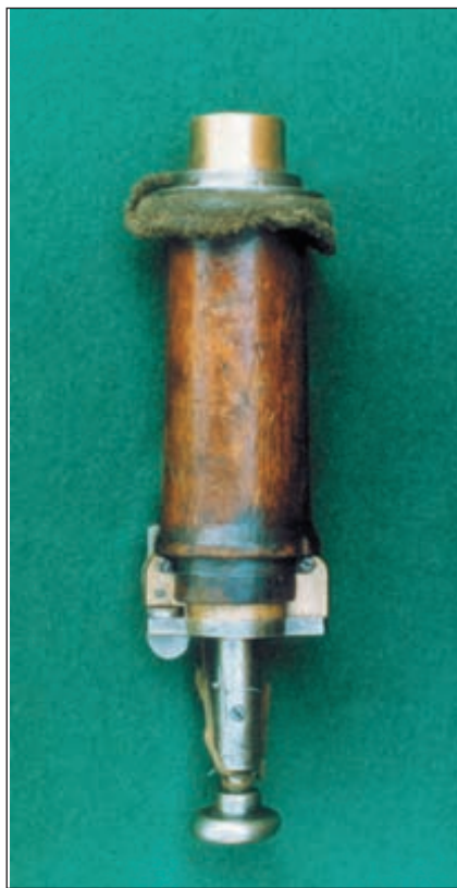
Прибор Бирнштейна Общая длина 235мм, длина ствола 161 мм, масса прибора 815 г
