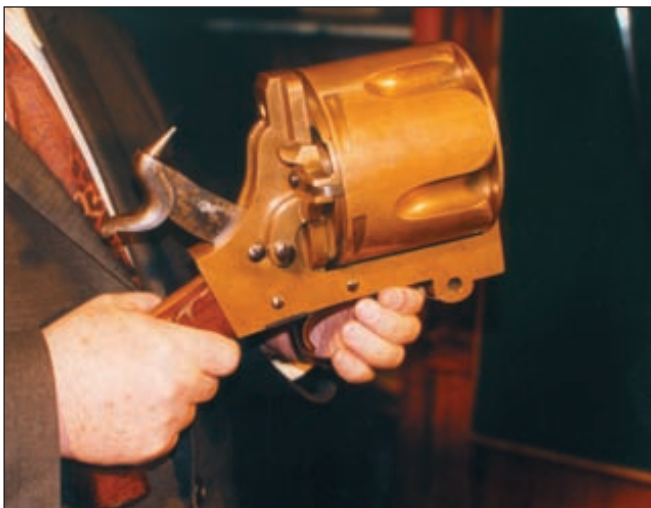
Пятизарядный сигнальный револьвер конструкции Пестича. Масса револьвера 9,5 кг, калибр – 37 мм. Цифрами на схеме обозначены: 1 – барабан; 2 – ось барабана; 3 – курок; 4 – боевая пружина; 5 – пружина спускового крючка; 6 – спусковой крючок; 7 – рычаг предохранительного взвода; 8 – пружина рычага предохранительного взвода; 9 – собачка с пружиной
