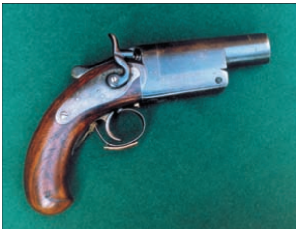
Сигнальный пистолет обр. 1910 г., разработанный полковником Зыбиным. Калибр осветительного пистолета образца 1910 г. 27 мм, общая длина 248 мм, масса 1183 г. Пистолет производился на Императорском Тульском оружейном заводе
