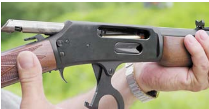
Непродолжительная тренировка с рычагом позволяет добиться очень высокой скорости перезарядания, недостижимой для оружия с поворотным затвором
