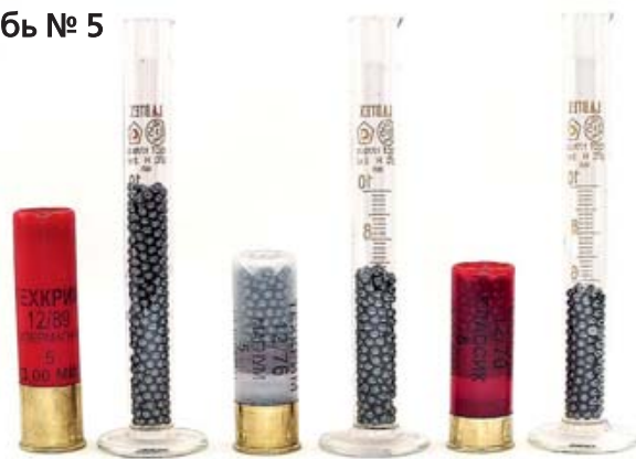
Сравнение дробовых патронов 12-го калибра с различной длиной гильзы.
