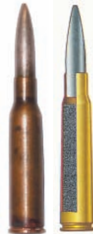
Японский патрон 6,5x50SR (слева) и патрон, разработанный В. Г. Фёдоровым
