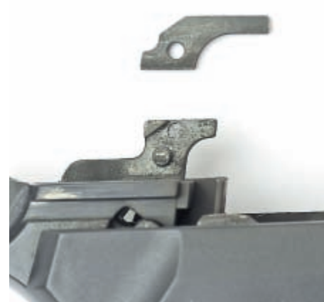
После 1000 выстрелов расклепался фиксирующий штифт отражателя без потери работоспособности последнего
