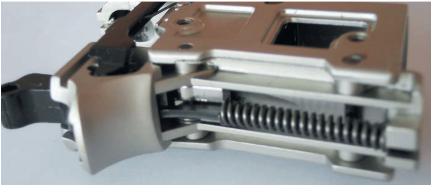
Следующая партия «Стримеров», поставляемых в Россию, будет оснащена боевой пружиной новой конструкции – спуск станет мягче, а износ курка и затвора меньше
