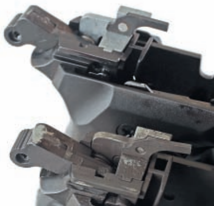
Хорошо виден нагар на деталях УСМ и износ курка в месте его контакта с затвором
