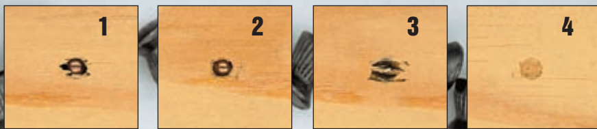
Результаты стрельбы по деревянному бруску (вверху, М 1:1) и при попадании в сучок (справа) (М 2:1): 1 – МР-651, 2 – МР-661К «Дрозд», 3 – ИЖ-61, 4 – Walther PPKS
