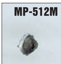
Внешний вид пуль после попадания в бетонную стену
