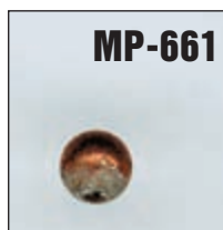
Внешний вид пуль после попадания в бетонную стену
