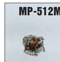
Внешний вид пуль после попадания в чугунную деталь
