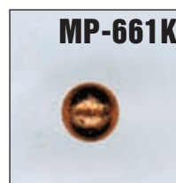
Внешний вид пуль после попадания в чугунную деталь
