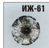
Внешний вид пуль после попадания в чугунную деталь
