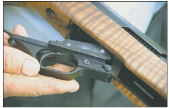
Ударно-спусковой механизм «Пионера» смонтирован на отдельном основании и легко отделяется от ствольной коробки для чистки и смазки
