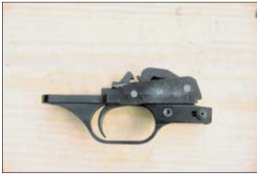
Ударно-спусковой механизм «Пионера» смонтирован на отдельном основании и легко отделяется от ствольной коробки для чистки и смазки
