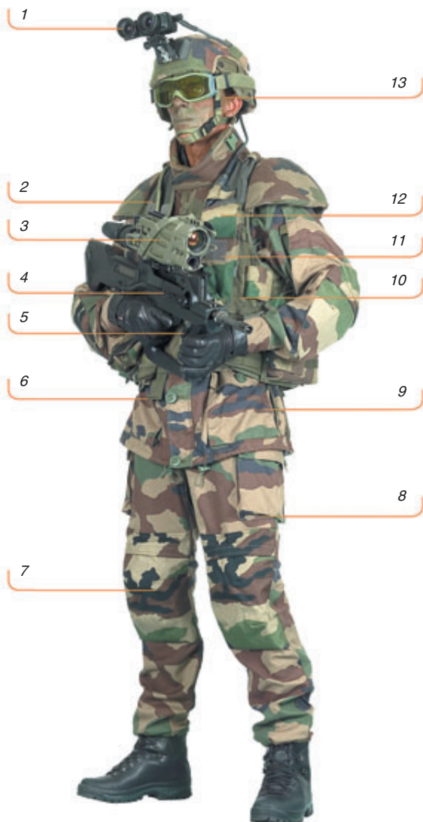
Состав системы FELIN: 1 – камера ночного видения и складной прицел для стрельбы, 2 – радиостанция и GPS приёмник, 3 – прицел дневного и ночного видения, 4 – модернизированная штурмовая винтовка FAMAS, 5 – панель дистанционного управления техническими средствами, 6 – источники питания, 7 – броненаколенники, 8 – высокоэффективный защитный материал, 9 – центральный компьютер, 10 – электронный жилет, 11 – бронезилет, 12 – экран компьютера, 13 – гарнитура остеофона
