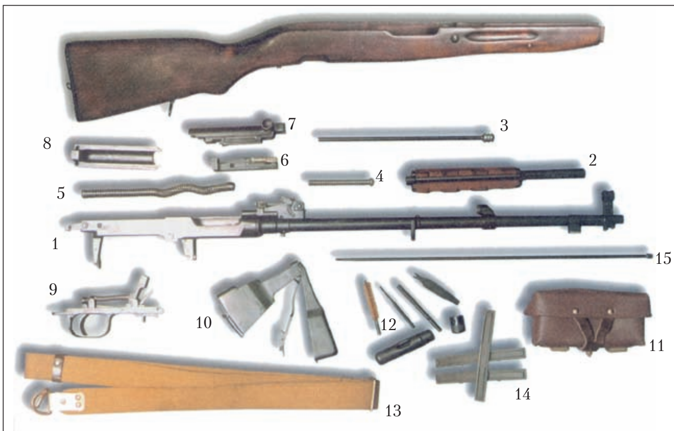
1 – ствол со ствольной коробкой; 2 – газовая трубка; 3 – шток с поршнем; 4 – толкатель с пружиной; 5 – возвратная пружина; 6 – затвор; 7 – затворная рама; 8 – крышка ствольной коробки; 9 – УСМ; 10 – магазин; 11 – подсумок; 12 – пенал с принадлежностью; 13 – погонный ремень; 14 – обоймы; 15 – шомпол
