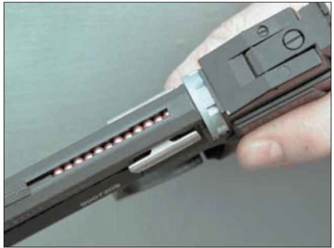
Трубчатый магазин для стальных шариков ВВ расположен над стволом. При стрельбе шарики сначала попадают в барабан, и при его повороте подаются на линию ствола
