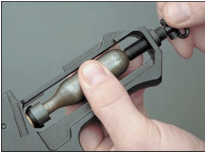
Основная масса пистолетов изготавливается под недорогой отечественный баллончик CO 2 . Процедура установки баллончика проста и не занимает много времени
