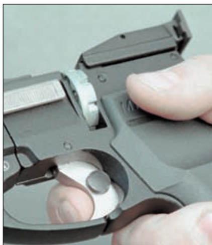
Кнопочный предохранитель находится на спусковом крючке и во включенном положении блокирует спусковой крючок
