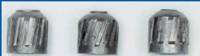
Пули Фостера которыми снаряжаются патроны производства БПЗ с различными головными частями
