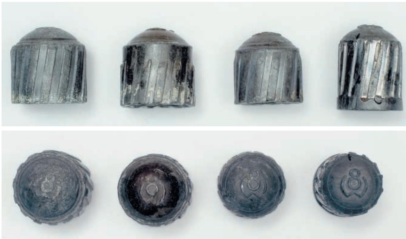
Польские пули W8 (аналог пули Фостера) различных калибров. На польских пулях W8 маркировка наносится на головную часть
