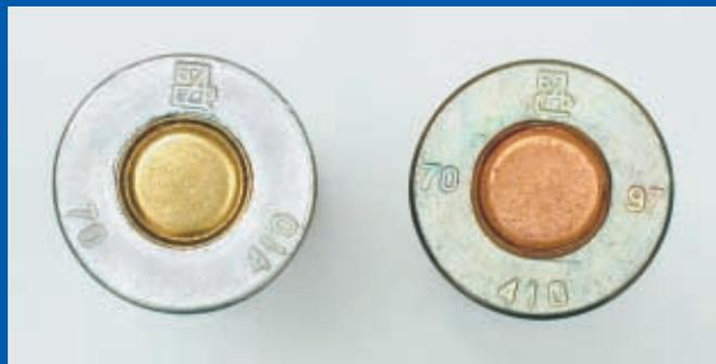
Маркировки, нанесённые на доннюю часть гильзы патронов Барнаульского станкостроительного завода (ныне Барнаульский патронный завод)
