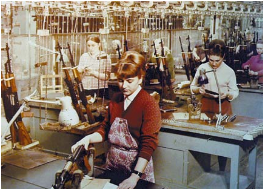
Конвейер по сборке автоматов Капалникова на Ижевском машиностроительном заводе. Фото 1960-х годов
