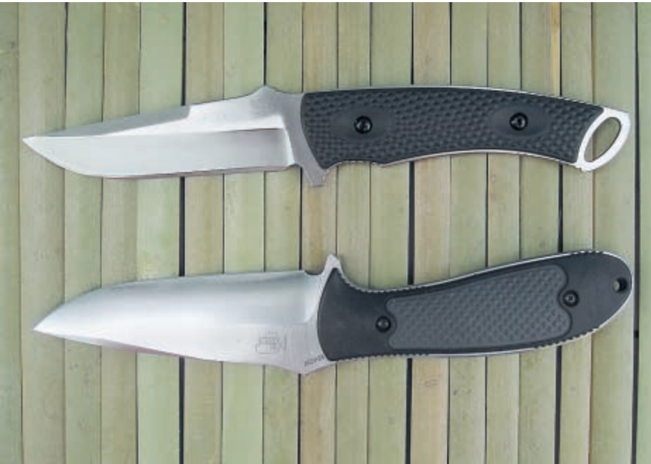
Конструкция, при которой рукоятка является продолжением клинка, обеспечивает ножу дополнительную прочность
