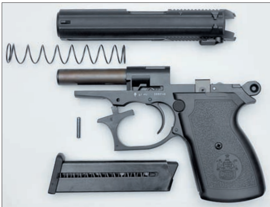
Неполная разборка травматического пистолета Mauser HSc Mod. 90. Обратите внимание – прежде, чем оттянуть спусковую скобу вниз, необходимо выбить фиксирующий штифт
