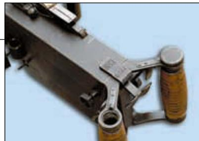
которого базировалась на более ранних разработках отца. Пулемёт с воздушным охлаждением и массой 36 фунтов, был устроен проще, чем широко распространённый образец MG 08/15. Пулемёт получил наименование «Бергман» обр. 1915 г. (7,92 мм). С 1916 г. он в больших количествах стал поступать на фронт.
