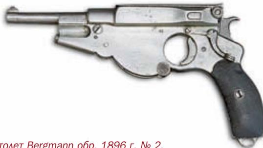
*Пистолет Bergmann обр. 1896 г. № 2, «новая модель», вариант. Калибр 5 мм. Одна из модификаций, отличающаяся несколько большими размерами и массой*
