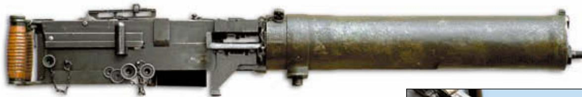
*Станковый пулемёт Dreyse MG 10 системы Л. Шмайссера. Калибр 7,92 мм. Принцип автоматики – короткий ход ствола. Ударный механизм куркового типа. Прицельная дальность стрельбы 2 000 м. Тело пулемёта устанавливалось на тяжёлом треножном станке, укомплектованном также и колесной парой*
