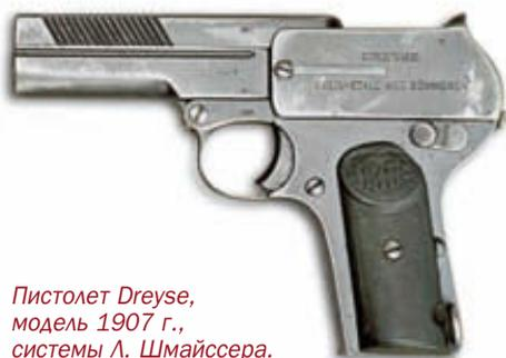
*Пистолет Dreyse, модель 1907 г., системы Л. Шмайссера. Принцип автоматики — свободный затвор. Ударно-спусковой механизм ударникового типа. Калибр 7,65 мм. Общая длина 158 мм. Длина ствола 91 мм. Масса 650 г. Вместимость магазина 7 патронов*
