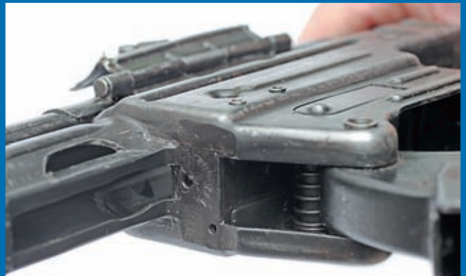
В ствольной коробке «штурмгевера» масса труднодоступных для чистки полостей
