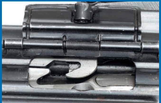
При открытой защитной шторке сочленение затворной рамы и затвора крайне легко загрязняется, что приводит к отказу оружия
