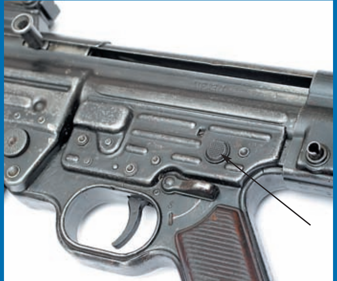
Рукоятка взведения затвора немецкого автомата расположена с левой стороны, а окно в ствольной коробке всегда открыто для грязи. Предохранитель управляется удобным флажком в основании рукоятки управления огнём. Переводчик режимов огня – кнопочный (указан стрелкой)
