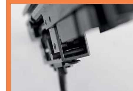
Переключатель «огонь-тренировка» в положении «тренировка». Поперечный стержень препятствует повороту курка до ударника своей цилиндрической частью
