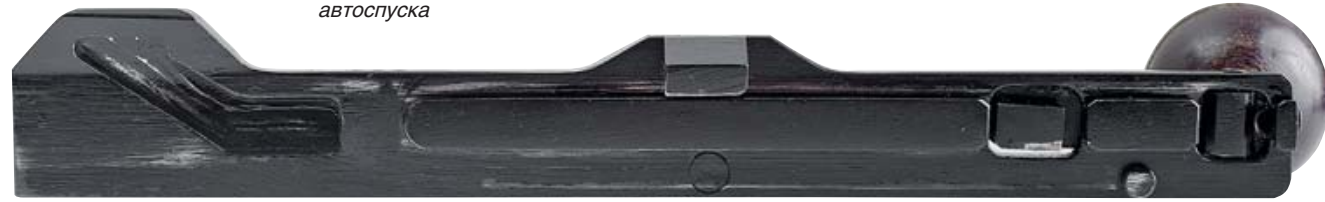
Затворная рама изнутри. Можно увидеть запирающую спираль с площадкой фиксации, направляющую затворной рамы, взводящий выступ и штифт сброса автоспуска
