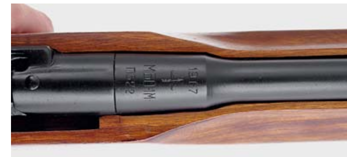
Маркировка винтовки включает наименование, номер, год изготовления и знак предприятия-изготовителя (лук со стрелой – эмблема Ижевского машиностроительного завода)
