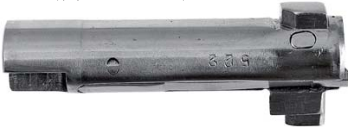
Слева от чашечки затвора расположен боевой выступ, совмещённый с запирающим выступом
