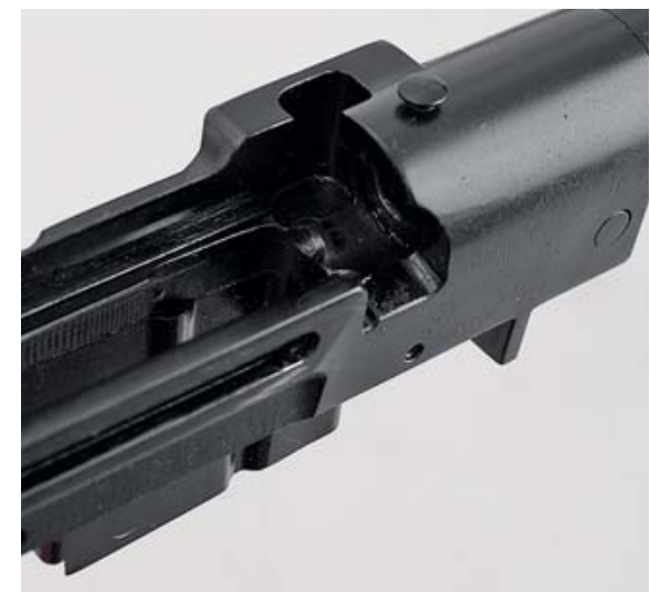
Котёл боевых упоров. Можно увидеть пенёк крепления противомиражной ленты, поверхность страгивания затвора, а также досылающие поверхности (2 пунки) в глубине ствольной коробки
