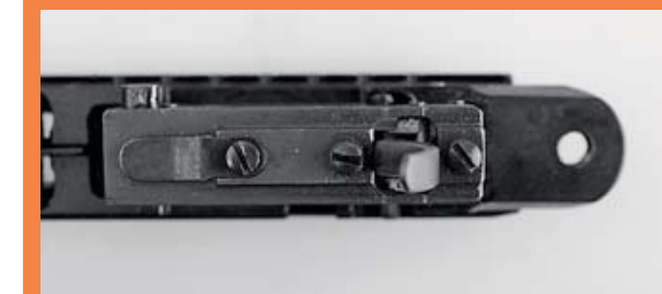
Пластинчатая пружина фиксации переключателя «огонь-тренировка». Также видны винты регулировки усилия спуска и хода спускового крючка
