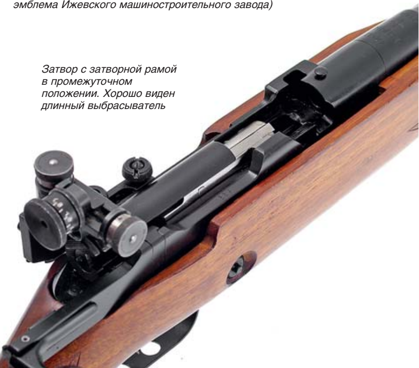
Маркировка винтовки включает наименование, номер, год изготовления и знак предприятия-изготовителя (лук со стрелой – эмблема Ижевского машиностроительного завода)
