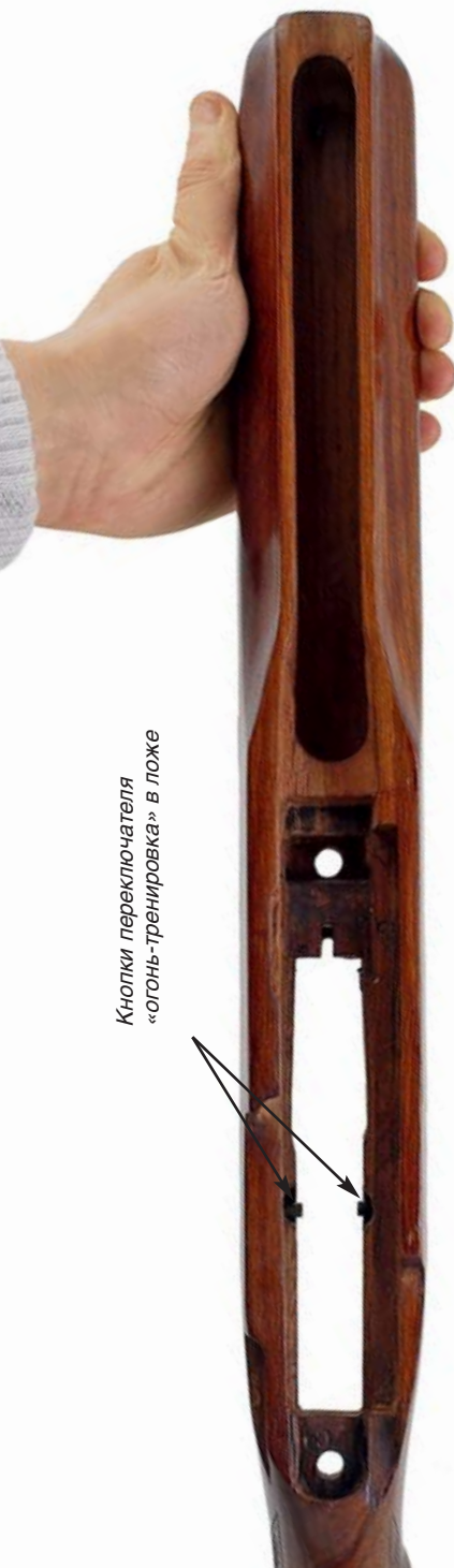
Выборка под укладку ствольной коробки и облегчение в районе цевья
