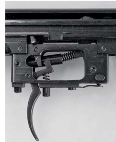
УСМ, курок спущен. Хорошо видно боевую пружину, частично выдвинувшуюся из кожуха
