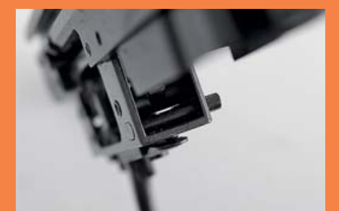
Переключатель «огонь-тренировка» в положении «огонь». Сейчас лыска стержня находится точно под курком, и он в свою очередь может нанести удар по ударнику
