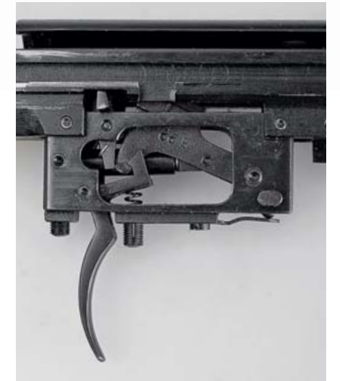
УСМ, курок взведён и находится на боевом взводе спускового крючка. Автоспуск поджимается своей пружиной к головной части курка и при взводе курка затворной рамой ставит курок на свой взвод
