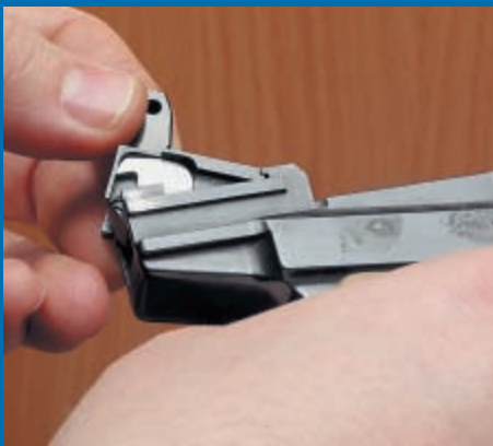
Часть УСМ с курком, шепталом и боевой пружиной легко извлекается из рамки пистолета
