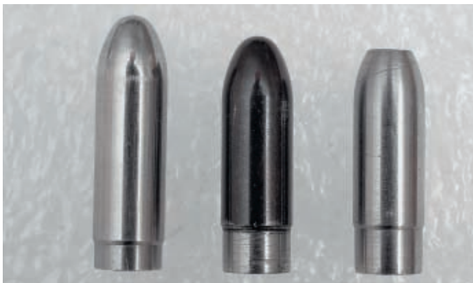
Внешний вид безгильзовых патронов Герасименко. Некоторые из них имеют срезанную головную часть и защитное покрытие (воронение)
