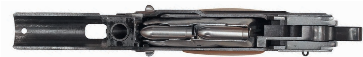
Патроны в магазине располагаются друг за другом. Ряды разделены перегородкой и каждый из них имеет свою пружину и подаватель
