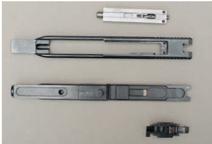
Сверху вниз: личинка затвора, затвор, ствольный блок (вид снизу) и легкосъёмная часть УСМ
