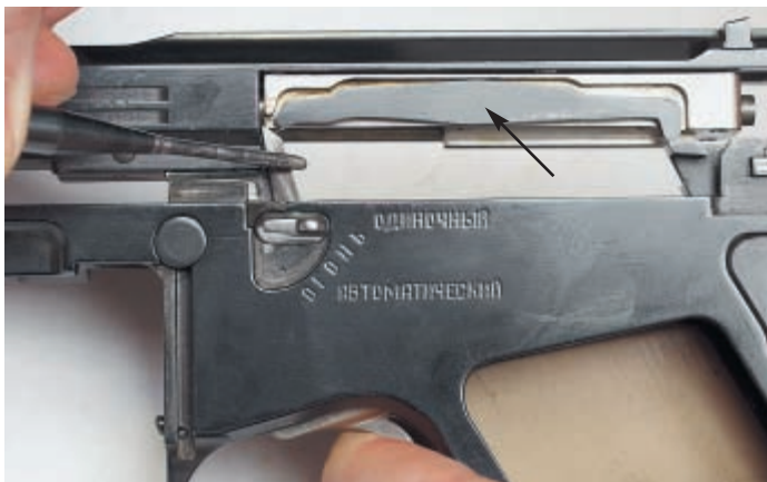
Толкатель спускового крючка в зависимости от положения переводчика режимов огня может либо свободно перемещаться вверх-вниз, либо жёстко фиксироваться. Стрелкой указан двуплечий рычаг, соединяющий толкатель с шепталом. На фото изображён пистолет с установленным ствольным блоком, личинкой затвора, но без затвора
