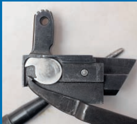
При стрельбе самовзводом курок взводится специальной тягой
