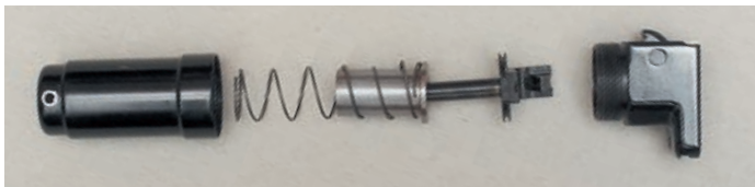
Пневматический замедлитель довольно прост по конструкции. Хорошо видно отверстие клапана в передней части цилиндра
