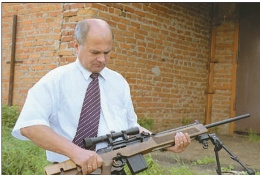
Поскольку «Вепрь-308 Супер Спорт» создан специально для высокоточной стрельбы, кронштейн для крепления оптического прицела доработан и имеет опорные поверхности в задней части
