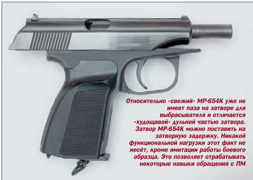
На ранних моделях имеется паз для выбрасывателя, а на самых первых образцах выбрасыватель имитировался и дульная часть затвора была идентична боевому пистолету Макарова
