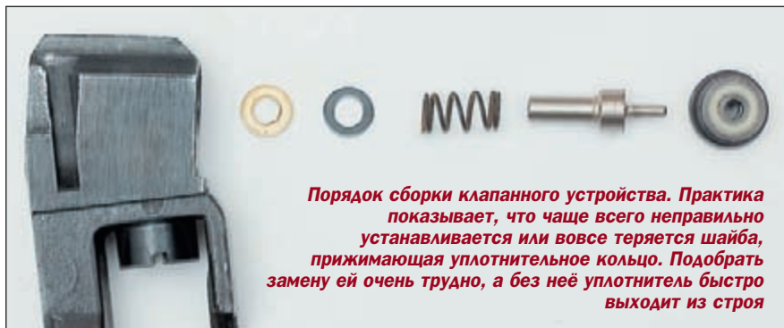
Слева на фото самое раннее клапанное устройство, в котором седлом клапана служило седло клапана пистолета МР-651К. В дальнейшем ПМ получил собственное седло, более подходящее для такого вида клапана. Современная головка иглы также имеет отличия по форме и конструктивно более удачна
