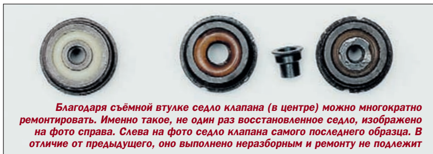
Порядок сборки клапанного устройства. Практика показывает, что чаще всего неправильно устанавливается или вовсе теряется шайба, прижимающая уплотнительное кольцо. Подобрать замену ей очень трудно, а без неё уплотнитель быстро выходит из строя
