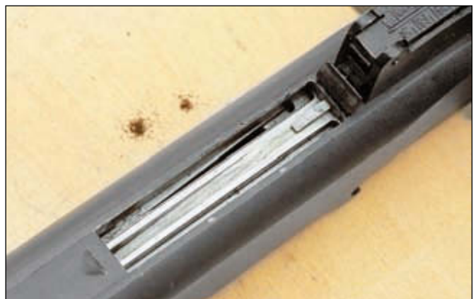
Подвижные части пулемёта находятся в переднем положении. Затвор заперт. Хорошо виден паз для отражателя на затворе и носик отражателя
