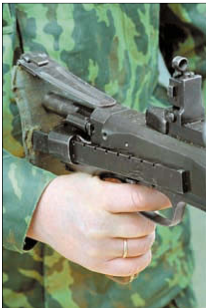
Пулемёт ДТ оснащён сдвижным прикладом и диоптрическим прицельным приспособлением
