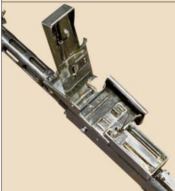
Вариант пулемёта ДП, приспособленный для использования матерчатой ленты пулемёта «максим». Лентоприёмник просто устанавливался вместо штатного магазина. При стрельбе его механизм приводился в действие двигающейся рукояткой перезарядки. Поддача ленты правосторонняя
