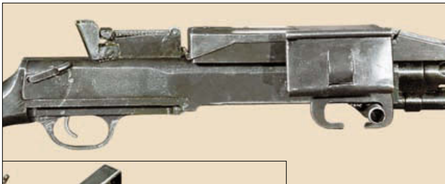
Вариант пулемёта ДП, приспособленный для использования матерчатой ленты пулемёта «максим». Лентоприёмник просто устанавливался вместо штатного магазина. При стрельбе его механизм приводился в действие двигающейся рукояткой перезарядки. Поддача ленты правосторонняя
