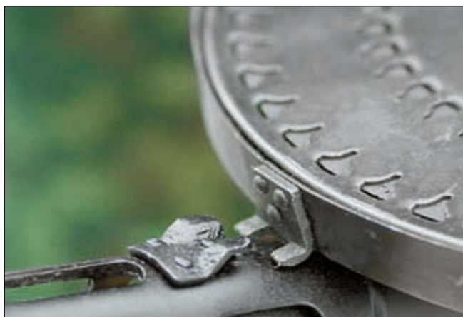
Дисковый магазин пулемёта ДП вмещал 47 патронов. Для заряжания пулемёта перед установкой магазина было необходимо сдвинуть вперёд пылезащитный щитик, закрывающий верхнее окно ствольной коробки и отвести подвижные части в заднее положение. Установить зацепы мазина в специальный упор и присоединить магазин. Для отсоединения магазина нужно оттянуть предохранитель прицела назад и снять магазин
