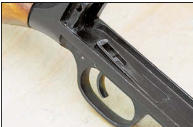
Спусковой механизм пулемёта чрезвычайно прост по устройству и состоит из 3 деталей: спускового крючка, пружины спускового механизма и спусковой рамы (показана стрелкой)
