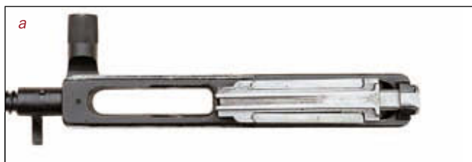
а – положение деталей запирающего механизма при незапертом затворе, подвижные части в крайнем заднем положении
