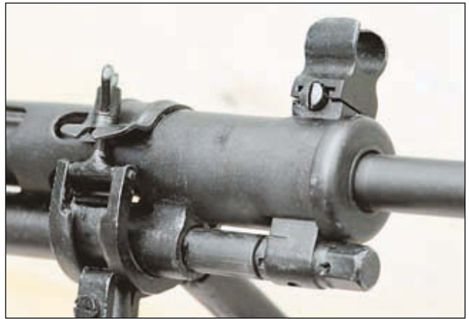
Мушка пулемёта регулировалась в двух плоскостях. Пулемёт комплектовался съёмной сошкой и имел газовый регулятор
