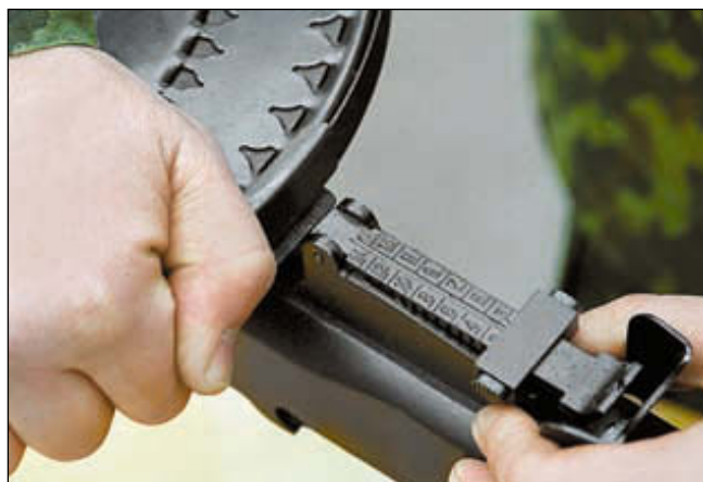
Дисковый магазин пулемёта ДП вмещал 47 патронов. Для заряжания пулемёта перед установкой магазина было необходимо сдвинуть вперёд пылезащитный щитик, закрывающий верхнее окно ствольной коробки и отвести подвижные части в заднее положение. Установить зацепы мазина в специальный упор и присоединить магазин. Для отсоединения магазина нужно оттянуть предохранитель прицела назад и снять магазин
