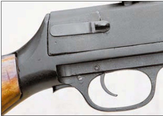
Автоматический предохранитель пулемёта расположен за спусковой скобой. С правой стороны задней части ствольной коробки расположен соединительный винт, который соединяет ствольную коробку со спусковой рамой
