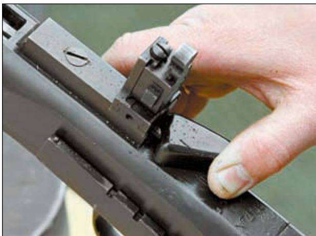
На танковом варианте пулемёта была изменена конструкция защёлки магазина. Теперь для отсоединения магазина достаточно было повернуть рычаг защёлки вправо или влево
