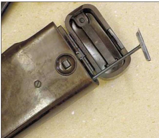
В полости кобуры располагается шомпол-отвёртка; крышка кобуры принудительно откинута пружиной, на иллюстрации справа хорошо видна пружинная клипса кобуры
