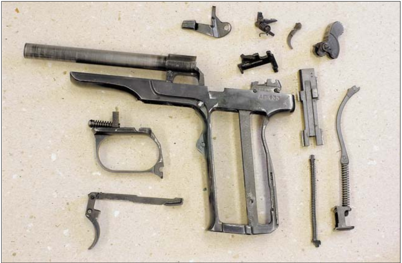
Рамка со стволом, спусковая скоба и детали ударно-спускового механизма пистолета АПС
