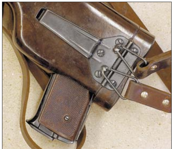
В полости кобуры располагается шомпол-отвёртка; крышка кобуры принудительно откинута пружиной, на иллюстрации справа хорошо видна пружинная клипса кобуры
