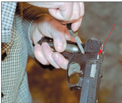
Для того, чтобы установить «Компакт» на МР-651К необходимо: 1 – снять с пистолета основание целика; 2 – отделить щиток с правой стороны рамки пистолета; 3 – надфилем или бормашинкой прорезать до конца вперёд посадочные места (указаны стрелкой) под захваты прицела; 4 – надфилем прорезать паз для винта кронштейна; 5 – присоединить прицел и затянуть крепёжный винт
