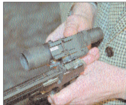
Для того, чтобы установить «Компакт» на МР-651К необходимо: 1 – снять с пистолета основание целика; 2 – отделить щиток с правой стороны рамки пистолета; 3 – надфилем или бормашинкой прорезать до конца вперёд посадочные места (указаны стрелкой) под захваты прицела; 4 – надфилем прорезать паз для винта кронштейна; 5 – присоединить прицел и затянуть крепёжный винт
