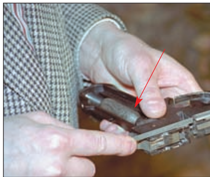
Для того, чтобы установить «Компакт» на МР-651К необходимо: 1 – снять с пистолета основание целика; 2 – отделить щиток с правой стороны рамки пистолета; 3 – надфилем или бормашинкой прорезать до конца вперёд посадочные места (указаны стрелкой) под захваты прицела; 4 – надфилем прорезать паз для винта кронштейна; 5 – присоединить прицел и затянуть крепёжный винт
